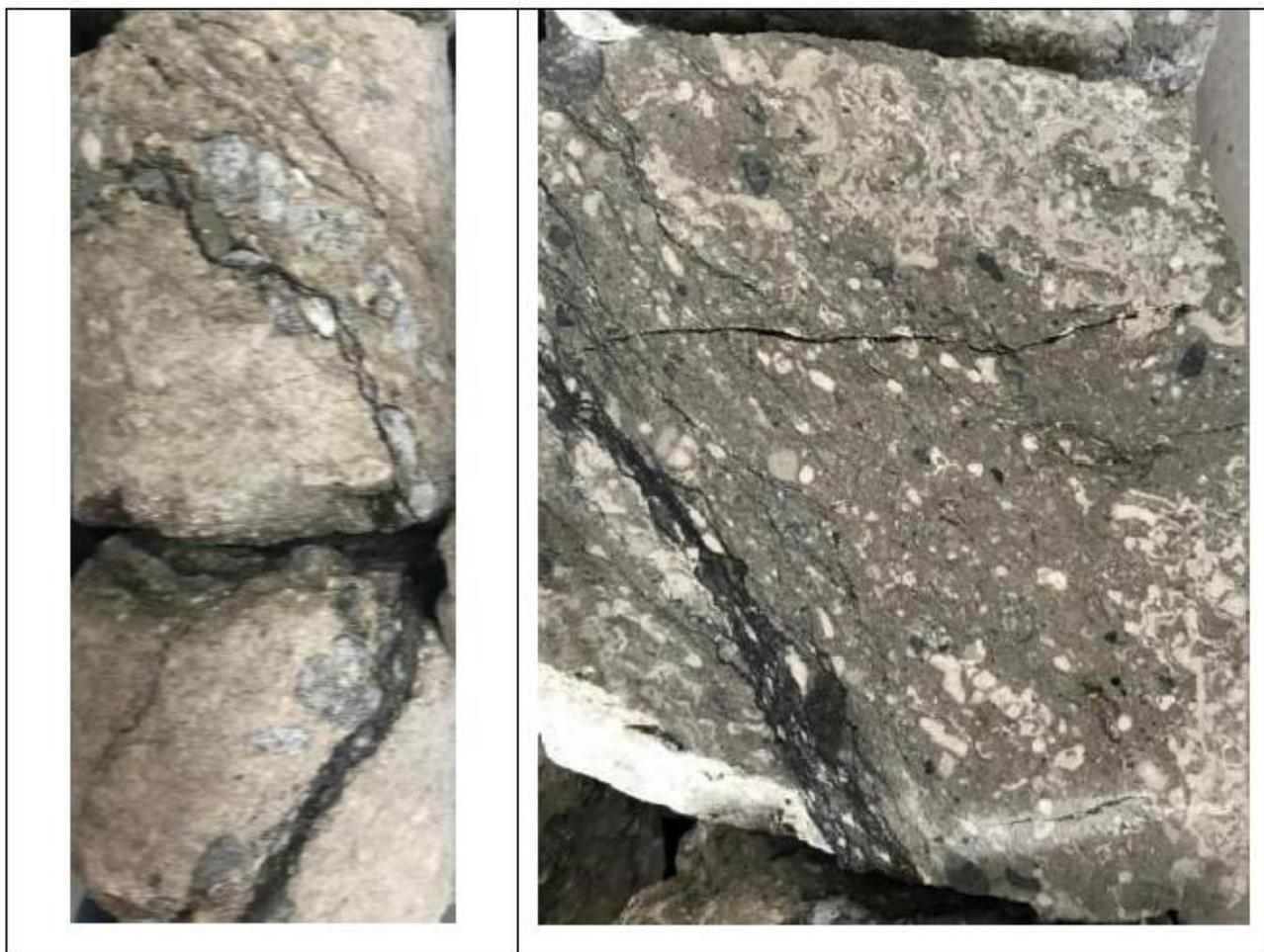
Рисунок 4.3 - Фрагмент пород в интервале органогенных известняков скважины № Is-X-10 (глубина 2586 м) – слева и срез верхнего фрагмента (в увеличенном масштабе) – справа
