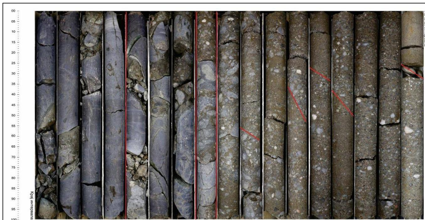
Рисунок 3.21 - Фотография пород базальных отложений, вскрытых скважиной № Is-X-4 на глубине 2293-2310 м
